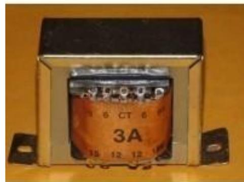
**Gambar 8** Bentuk Fisik Transformator
