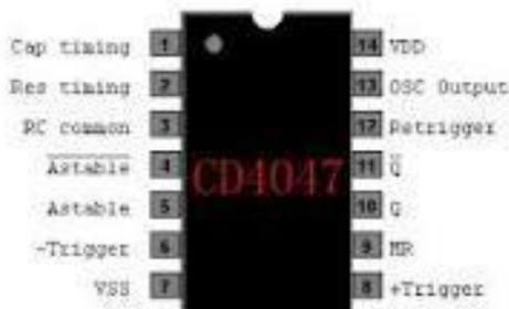
Gambar 10 Konfigurasi Pin IC CD4047
